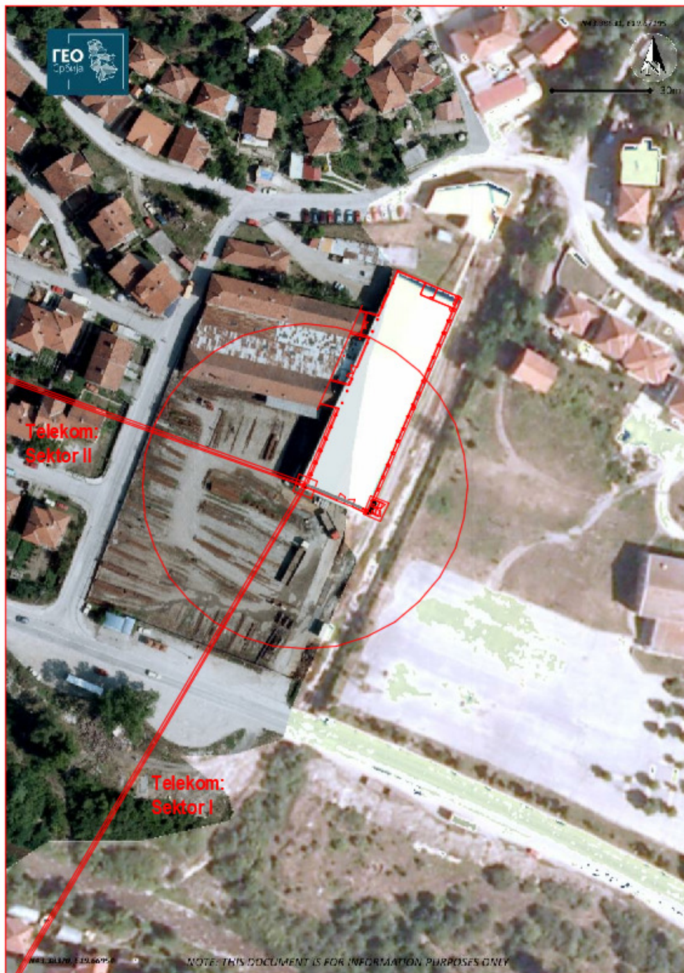
Slika 5.1 Dijagram zračenja radio bazne stanice "Prijepolje (Energomontaža)"- UE120/UEU120/UJL120/UEO120/UEJ120
