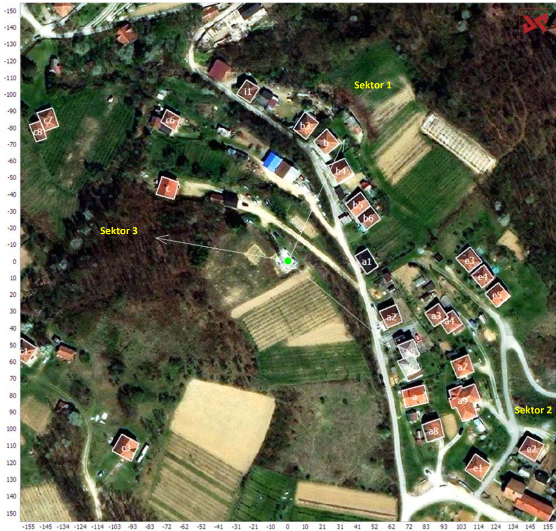
Slika 2.4 Prikaz pravaca zračenja antena bazne stanice i pozicije okolnih objekata
